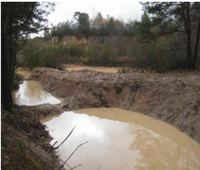
Bassins de décantation à la carrière de quartzite de Meillers
